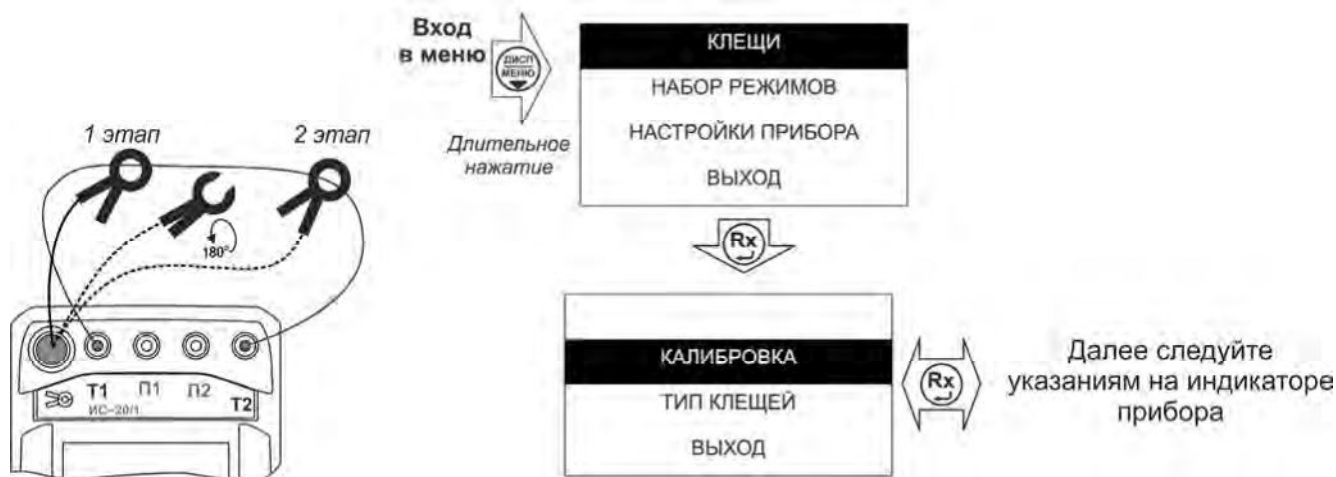
Рисунок 2.14 – Калибровка токоизмерительных клещей
