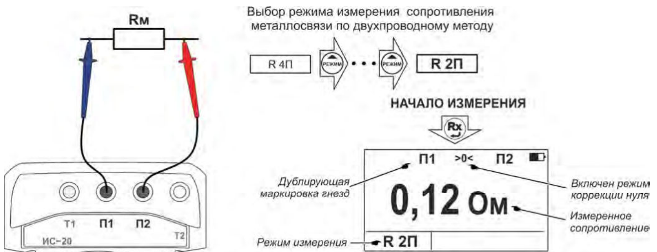
Рисунок 2.8 – Схема подключения и вид индикатора
